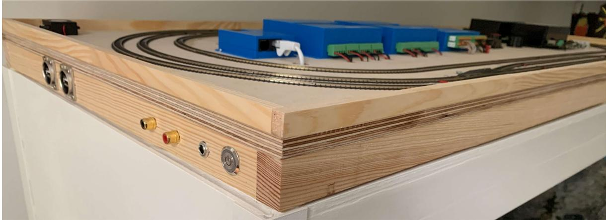
Auf der linken Seite sind die Anschlüsse. Dynamo wird, wie D&H, über ein USB-Kabel mit dem PC verbunden. Die Chinch-Buchsen sind für den Ton vom PC kommend (2 Lautsprecher sind auf der Anlage verbaut mit kleinem Verstärker-Modul).
